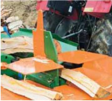
As Maquinas SplitMaster 20, 26 e 30 podem facilmente serem convertidas em SplitMaster "Easy", basta pedir a opção Y ( opção de faca especial Y) para que seu serviço seja facilitado! A opção "Easy" também inclui um pegador de lenha utilizável com apenas uma das mãos.
